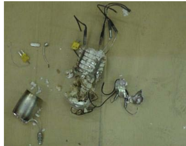
圖：實驗用測試罐因內部反應壓力過大導致失控爆炸後之殘留物
