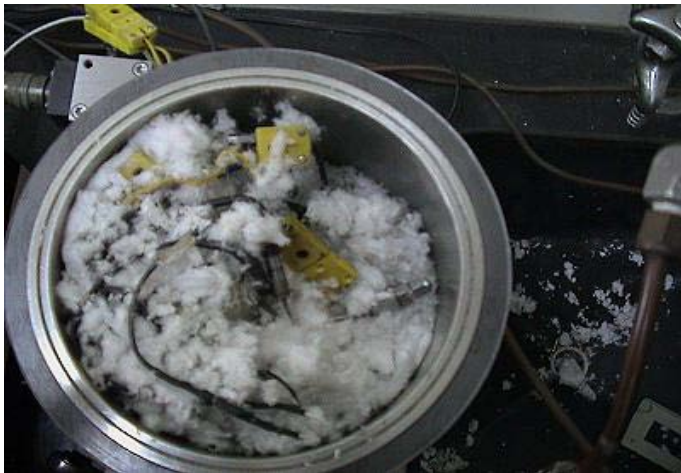
圖：實驗用儀器因內部反應壓力過大導致失控爆炸損壞
